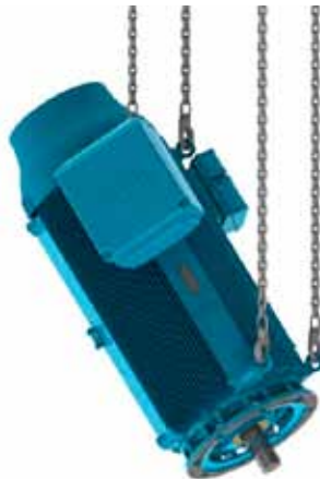
Figura 4.13 - Colocación de motor HGF en posición vertical.
