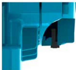
Figura 6.2 - Detalhe do dreno de borracha montado na posição fechado.
