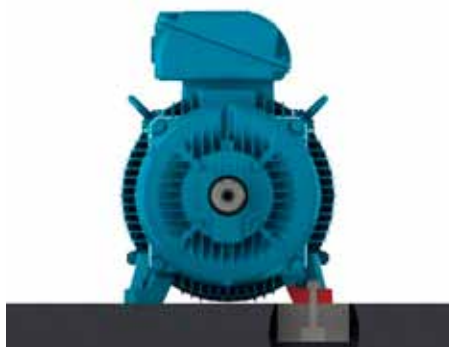
Figura 6.3 – Motor instalado sobre base de concreto.
