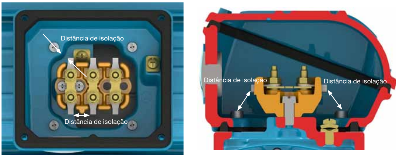
Figura 6.13 - Representação da distância de isolamento.
