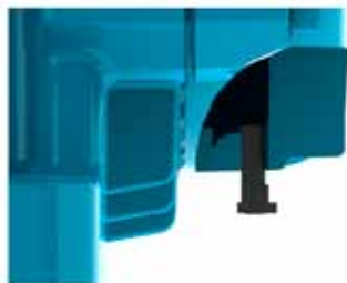
Figura 6.1 - Detalle del drenaje de goma montado en la posición abierto.
