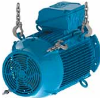
Figura 4.10 – Instalación del segundo par de ojales.
