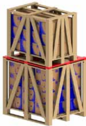
Figura 5.5 - Utilización de varas adicionales para apilamiento.
