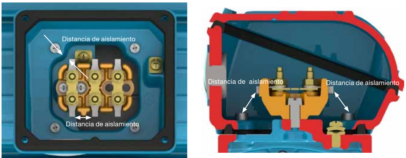
Figura 6.13 - Representación de la distancia de aislamiento.
