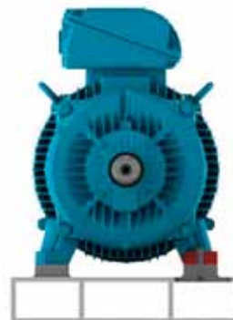
Figura 6.4 – Motor instalado sobre base metálica.
