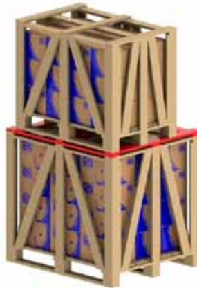
Figura 5.5 - Utilização de sarrafos adicionais para empilhamento.
