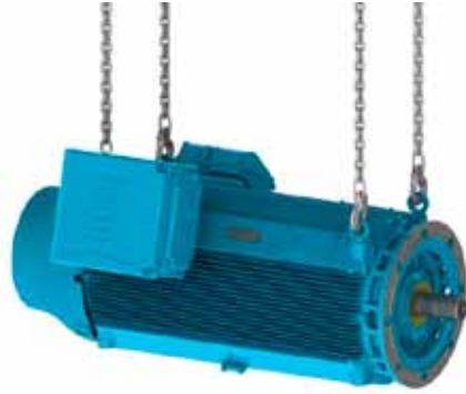
Figura 4.12 – Izamiento del motor HGF utilizando dos grúas.
